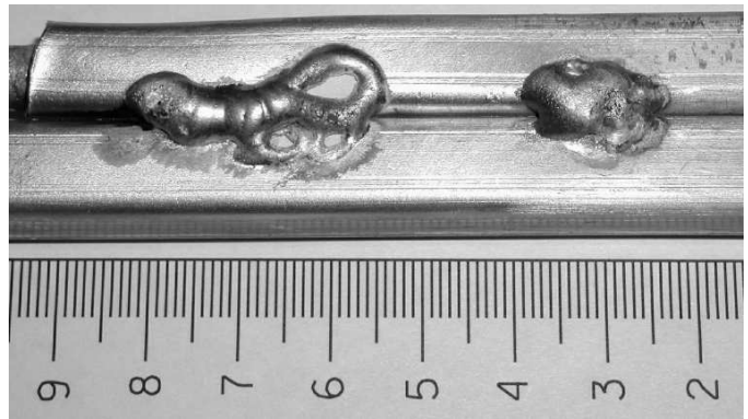
Fig. 3. Test weld on aluminum conduit.
